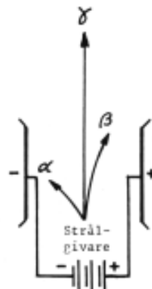
Bild 33. Alfa-, beta- och gammastrålarnas avböjning i elektriska fält.
